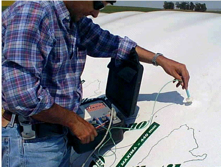
Figura 8. Determinación de la concentración de O_2 y CO_2 en el interior de las bolsas.
