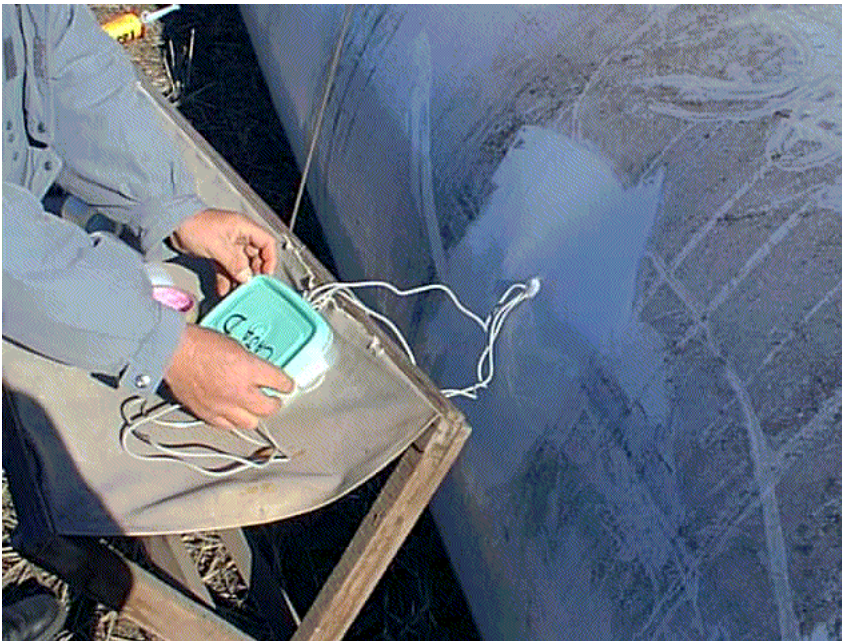
Figura 7. Instalación de la caja hermética conteniendo los dataloggers para la recolección de datos de temperatura.
