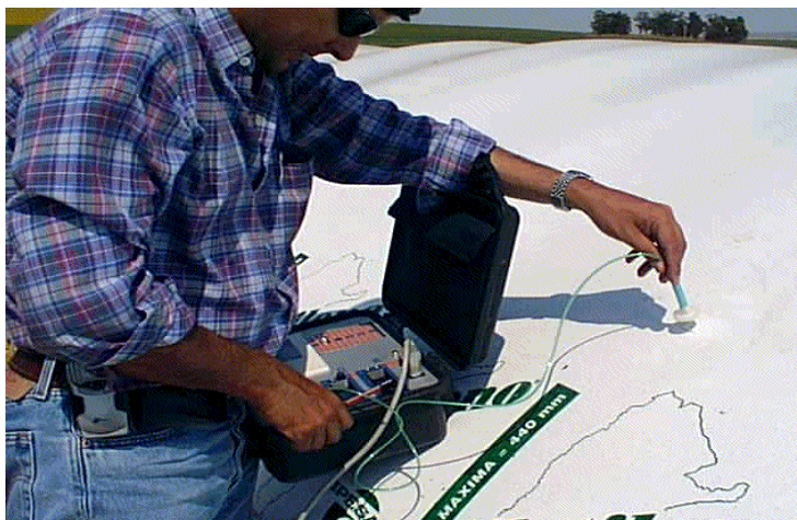
Figura 8. Determinación de la concentración de O 2 y CO 2 en el interior de las bolsas.
