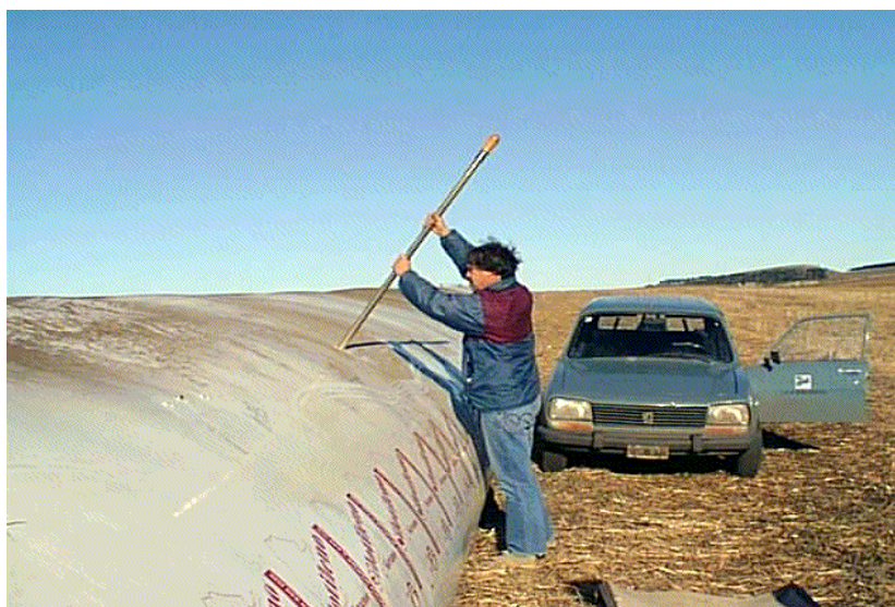
Figura 2. Toma de muestra perforando la bolsa con calador sonda.
