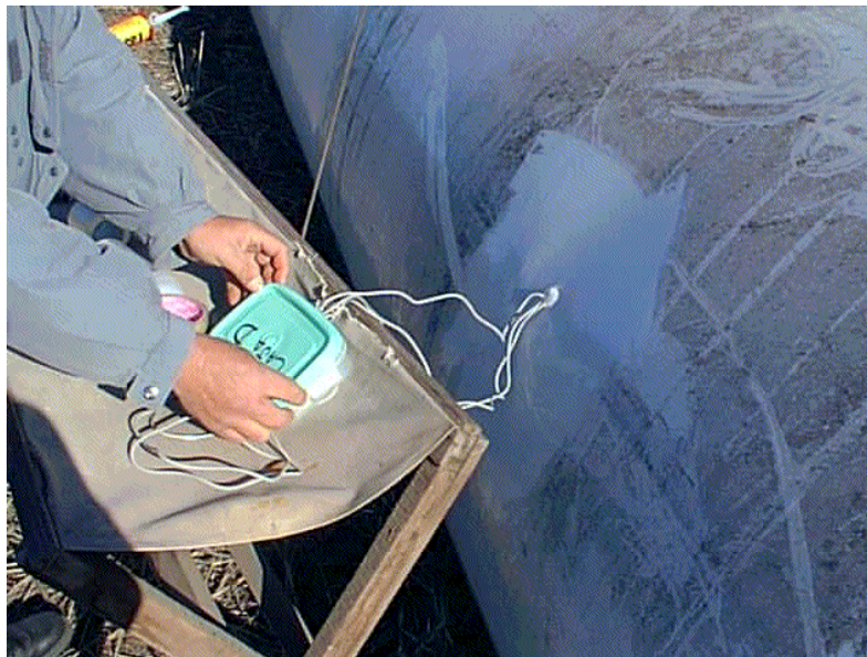
Figura 7. Instalación de la caja hermética conteniendo los dataloggers para la recolección de datos de temperatura.
