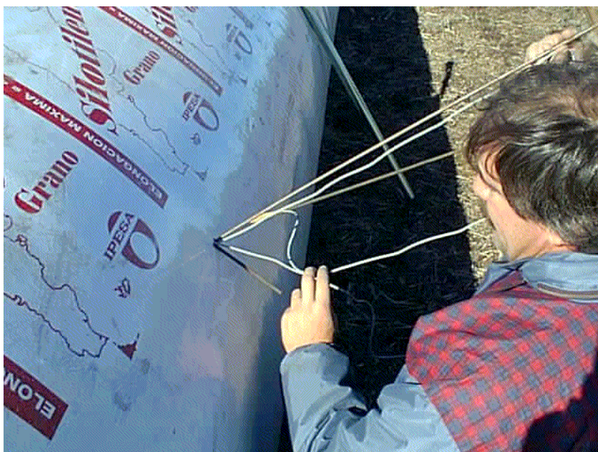
Figura 6. Instalación de sensores de temperatura en el interior de las bolsas. Cada una de las varillas corresponde a una
