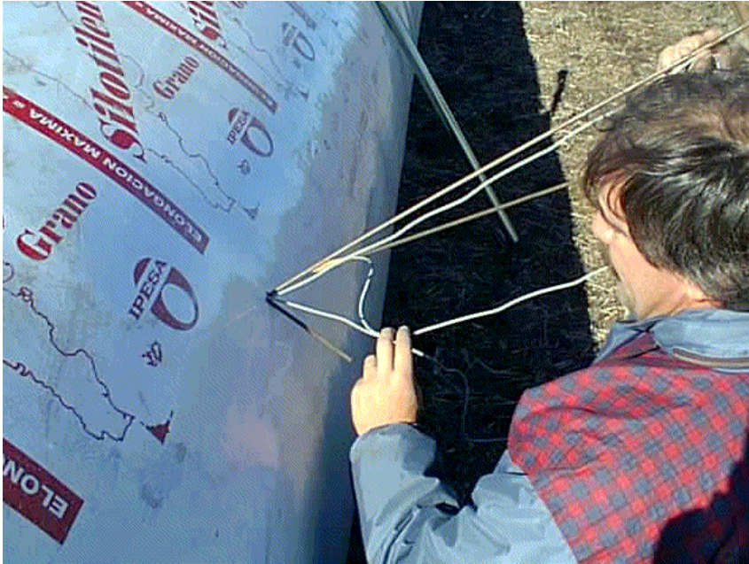
Figura 6. Instalación de sensores de temperatura en el interior de las bolsas. Cada una de las varillas corresponde a una ubicación dentro de la bolsa (superior, media e inferior).
