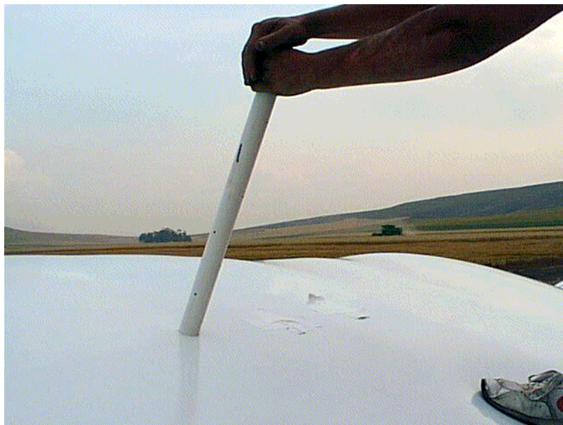
Figura 9. Colocación de los tubos conteniendo celdas con insectos vivos en el interior de las bolsas.
